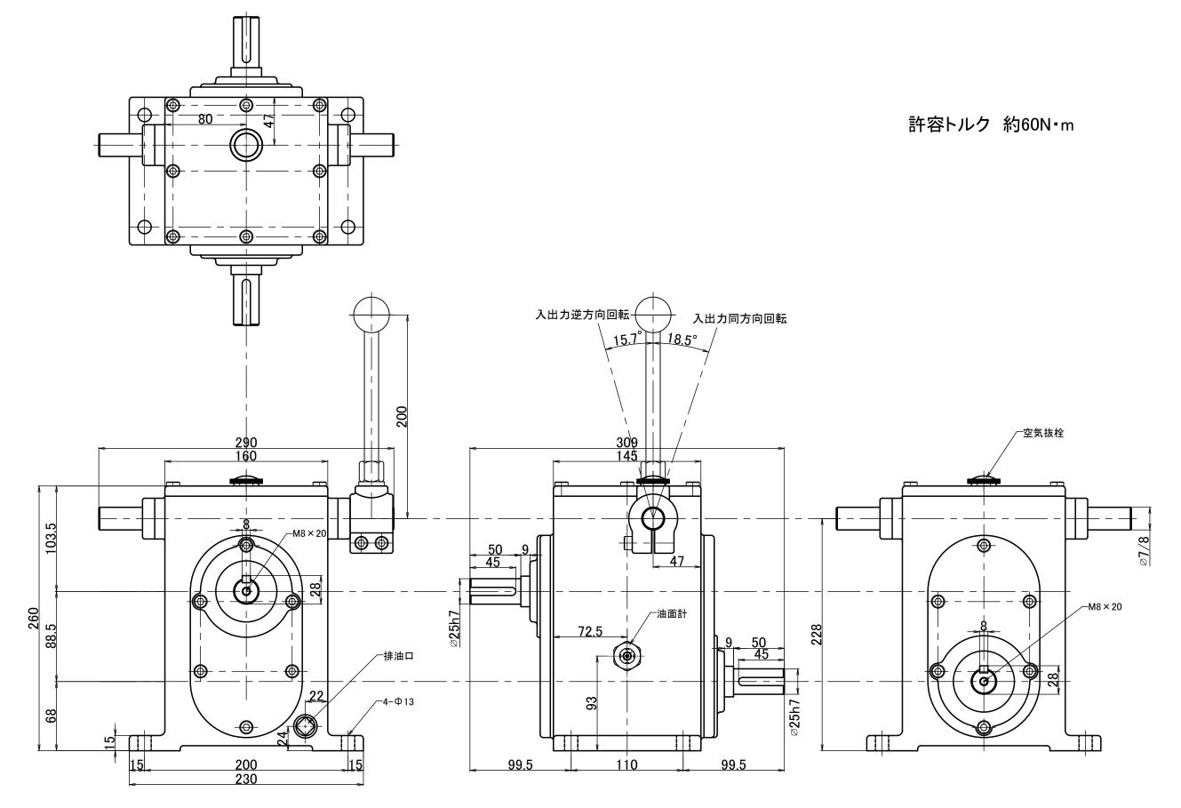
チェンジレバー長さ変更可 チェンジレバー反対側取付可
